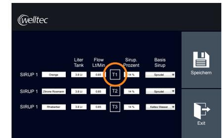
9 Mit dem folgenden Schritt sorgen Sie dafür, dass der Sirup-Rest aus dem Schlauch fließt und warmes Wasser nachgezogen wird. Tippen Sie zunächst auf die Taste T1 und stoppen Sie dann nach ca. 30 Sekunden den Vorgang aktiv, indem Sie erneut das Feld T1 drücken.
