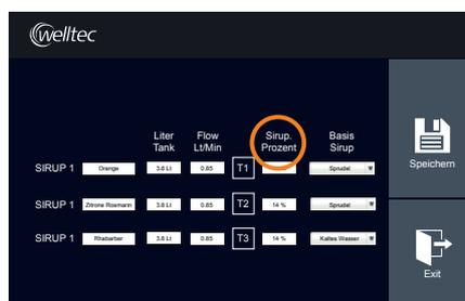
14 Im Feld „Sirup Prozent“ kann die Konzentration des Sirups im Getränk erhöht oder reduziert werden. Wir empfehlen die voreingestellten Werte beizubehalten.
