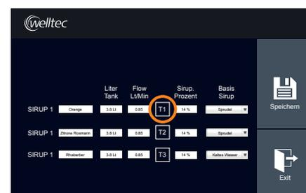
12 Drücken Sie die Taste T1, wenn der neue Kanister zur Sirup-Anschluss 1 gehört (Taste T2 bei Sirup-Anschluss 2 bzw. Taste T3 bei Sirup-Anschluss 3). Sobald reiner Sirup ohne Wasserreste aus dem Getränkeauslauf fließt, stoppen Sie den Vorgang aktiv, indem Sie erneut das Feld T1 (T2 oder T3) drücken.
